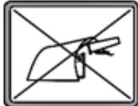
Ne pas recouvrir le canon effaroucheur par une bâche ni par des branchages.
