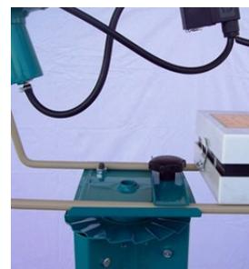
Dévisser le collier serflex du tuyau de gaz, débrancher le détendeur, faire glisser le tuyau de gaz propane dans l'axe du tripode.
