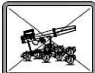
Ne pas placer le canon effaroucheur proche d'une zone d'herbe sèche, ou proche d'élément combustible.
