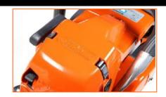
**Embrayage "ON BOARD"** avec cloche et sangle de frein intégrés dans le bloc moteur : évite la pénétration de corps étrangers entre les masses centrifuges afin de ne pas compromettre leur fonctionnement. Facilite les phases de démontage du carter de protection de la chaîne, simplifie les opérations de nettoyage et d'entretien courant.
