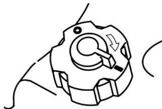
6. Amener le régulateur de régime moteur (03/C) jusqu'en butée avant.
