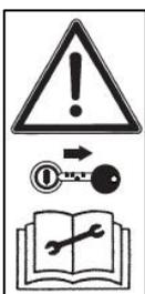
**DANGER** - Avant d'effectuer toute opération de contrôle, de nettoyage et d'entretien sur la machine, arrêtez le moteur, retirez la clé de contact et suivez les instructions du manuel.
