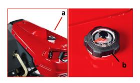
Le **régulateur de vitesse MICRODRIVE** permet par enclenchement du levier (b) de maintenir une vitesse fixe sans appuyer sur la commande d'avancement.
