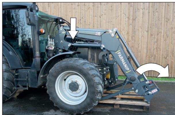
— Avancer lentement le tracteur et jusqu'à ce que les cadres arrivent en butée.
