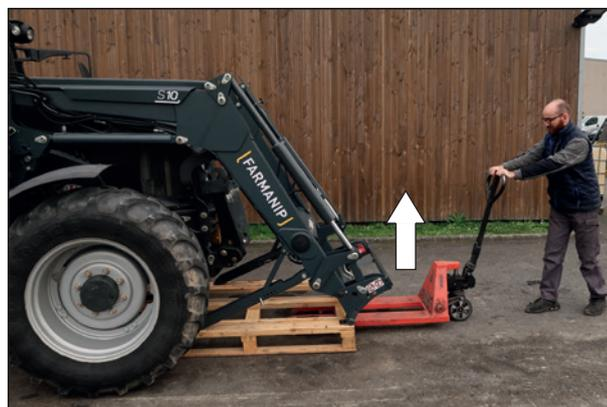
— Verrouiller le cadre du chargeur sur l'adaptation avec les broches.
