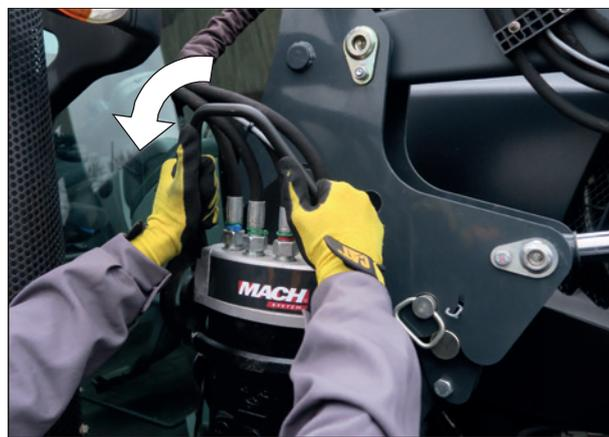
— Connecter l'hydraulique et l'électrique. Chargeur sans MACH System :
