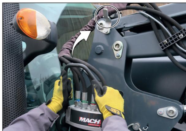
— Déconnecter l'hydraulique et l'électrique. Chargeur sans MACH System :
