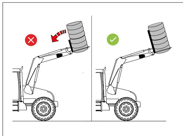
— Le niveau maximal de chargement de l'outil ne doit pas dépasser la paroi la plus basse dans le cas du vrac, et ne pas dépasser la hauteur du dossier dans le cas de charges unitaires.
