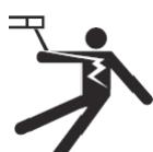
Das Schweißgerät darf ausschließlich an einer geerdeten Netzversorgung betrieben werden. Verwenden Sie nur die empfohlenen Sicherungen.
