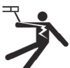
Le réseau électrique utilisé doit impérativement avoir une mise à la terre. Utiliser la taille de fusible recommandée sur le tableau signalétique.
