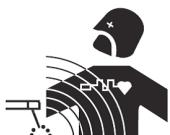
Elektrische stroom die door een geleider gaat veroorzaakt elektrische en magnetische velden. De lasstroom wekt een elektromagnetisch veld op rondom de laszone en het lasmateriaal.
