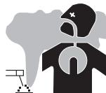
Dampen, gassen en stof uitgestoten tijdens het lassen zijn gevaarlijk voor de gezondheid. Zorg voor voldoende ventilatie, soms is toevoer van verse lucht tijdens het lassen noodzakelijk. Een lashelm met verse luchtaanvoer kan een oplossing zijn als er onvoldoende ventilatie is. Controleer of de zuigkracht voldoende is, en verifieer of deze aan de gerelateerde veiligheidsnormen voldoet.
