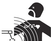
Le courant électrique passant à travers n'importe quel conducteur produit des champs électriques et magnétiques (EMF) localisés. Le courant de soudage produit un champ électromagnétique autour du circuit de soudage et du matériel de soudage.
