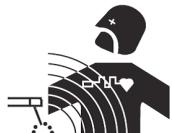
La corrente elettrica passando attraverso a qualunque conduttore prodotto dai campi elettrici e magnetici (EMF) localizzati. La corrente di saldatura produce un campo elettromagnetico attorno al circuito di saldatura e al dispositivo di saldatura.
