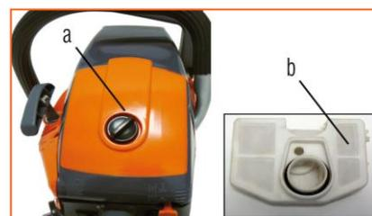
Le **réservoir de carburant est séparé du carter moteur (fig.a)** ce qui évite l'échauffement du mélange et garantit des **performances stables**.
