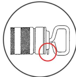
Système de blocage de la tige de piston. Grâce à ce système, la tige, ne peut-être débloquée accidentellement. Le cliquet est continuellement en position de blocage par l'effet du ressort.
