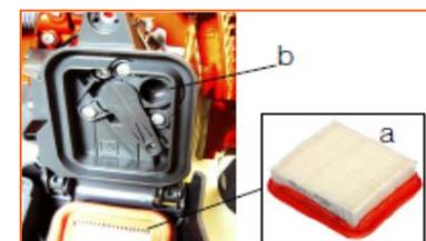
**Cache-filtre accessible** : contrôle et nettoyage du filtre à air facilités.
