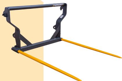
Un outil simple pour les travaux de manutention de bottes rondes ou rectangulaires, disponible en attelage EURO uniquement, le pique-botte est équipé de 2 doigts ronds démontables Ø35 x 1000 mm, permettant ainsi la manutention d'une botte d'un poids maximum de 650 kg.
