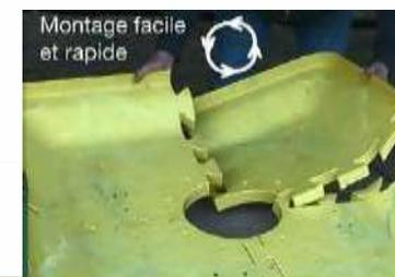
**MODULO-BAG: système de vidange de big-bags permettant à partir d'un module central d'y ajouter d'autres tables**
