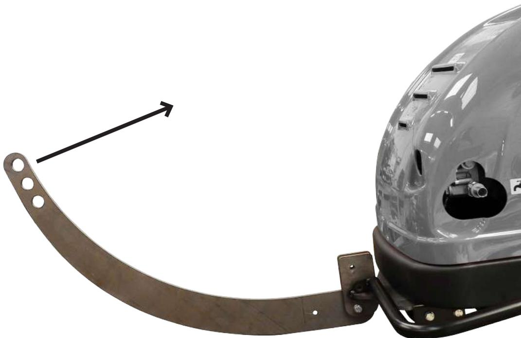
8 - Visser le boulon du haut de la barre de protection latérale sur la plaque de protection avant, à travers la barre de protection avant.
