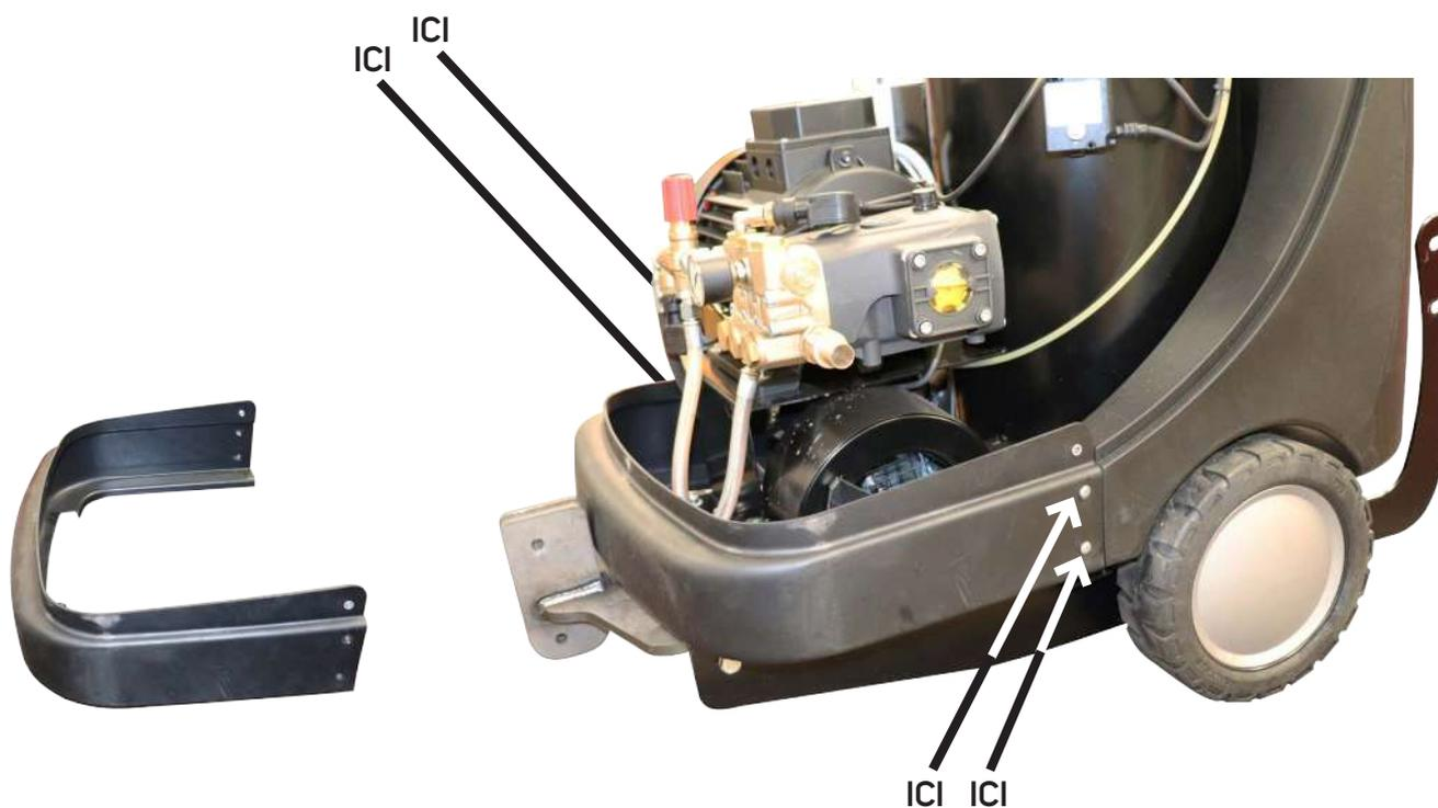
3 - Positionner le capot sur le nettoyeur et visser les boulons de fixation.
