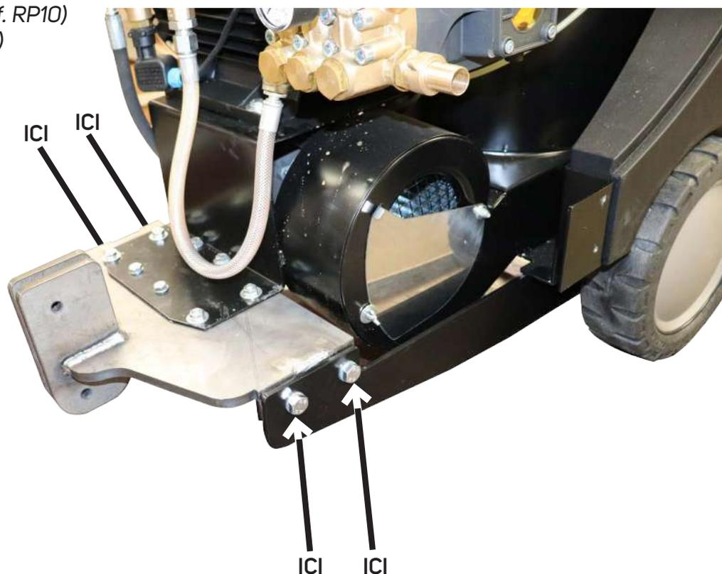
6 - Finir de visser à fond les boulons des barres de soutien latérales sur la barre arrière.
